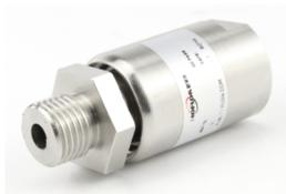
MK11A系列单通道旋转接头，接口尺寸G1/8"，结构紧凑，重量轻，耐腐蚀。所有MK系列机型均标配阳螺纹轴和阴螺纹外壳，便于安装。
